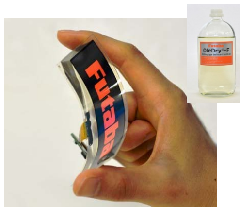
乾燥剤「OleDry-F」を利用した フィルム型有機ELディスプレイ
