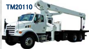
TM20110 (写真製品：北米向け20t吊りバームトラック)
