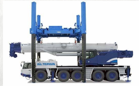
オールテレーンクレーンブーム着脱作業例 CL-500
