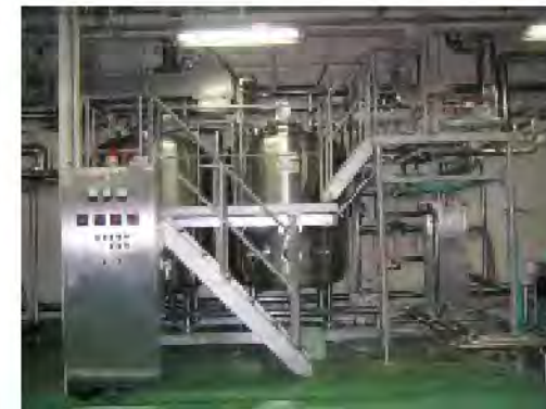
CIP洗浄設備 配管内を分解せずに洗浄
